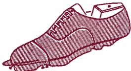
Spitze zwicken auf der Zwickmaschine. Die Vorderkappenpartie wird nach dem Auszwicken durch einen seitlich an zwei Stiften fixierten Draht fesgehalten. (Bei neuen Spitzenzwickmaschinen wird das Oberleder durch heisse Scheren so festgezwick, dass der Draht nicht mehr benötigt wird).
